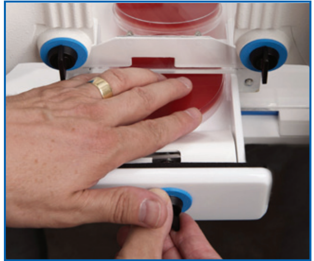
9cm Einplatteneinschub – für das schnelle Einbringen von einzelnen Proben
